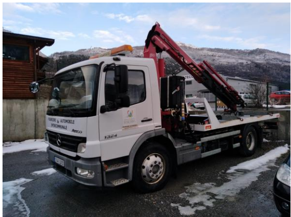
Camion fourrière transformé en camion de collecte compost (transformation en cours)
